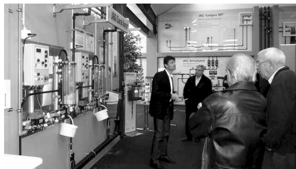
Eine der vielen Versuchsanlagen im neu gestalteten Trainings-Center: Hier geht es um die physikalische Wassernachbehandlung und Trinkwasserhygiene.
